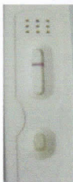
Gambar 1. Contoh rapid test MDMA Hasil positif, terbentuk garis pada tanda c (atau mengikuti instruksi pembacaan rapid test yang tertera pada lembar etiket)
